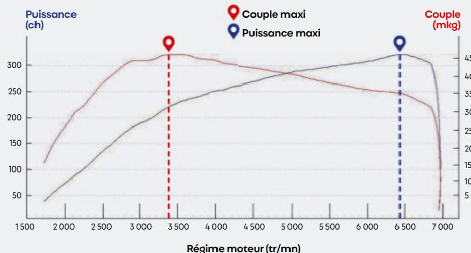
Mesures effectuées sur banc Superflow Windyn 2 ou 4 roues motrices, capable d'encaisser jusqu'à 1 200 ch par essieu. Après le calcul des pertes de transmission, les mesures sont réalisées en freinant les rouleaux et en les accélérant. C'est donc la force nécessaire à leur ralentissement et à leur accélération qui détermine le couple puis la puissance maxi.
