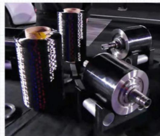
Tesla a développé son propre outil de production permettant d'enrouler de la fibre de carbone sous une très forte tension autour du rotor des moteurs électriques de la Model S Plaid.
